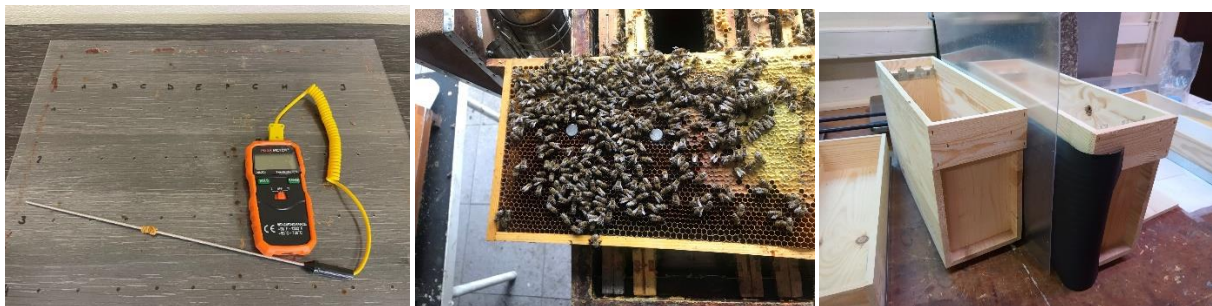
Figuur 1: Links: staafsensor om de broedtemperatuur te meten doorheen de dekplank. Midden: iButtons in de wasraten. Rechts: de kijkkast in opbouw.
